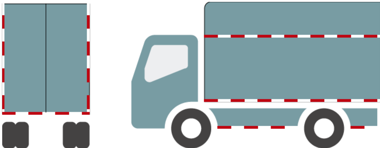
Figura 5. Ejemplo de colocación de cintas reflejantes en vehículos de carga
